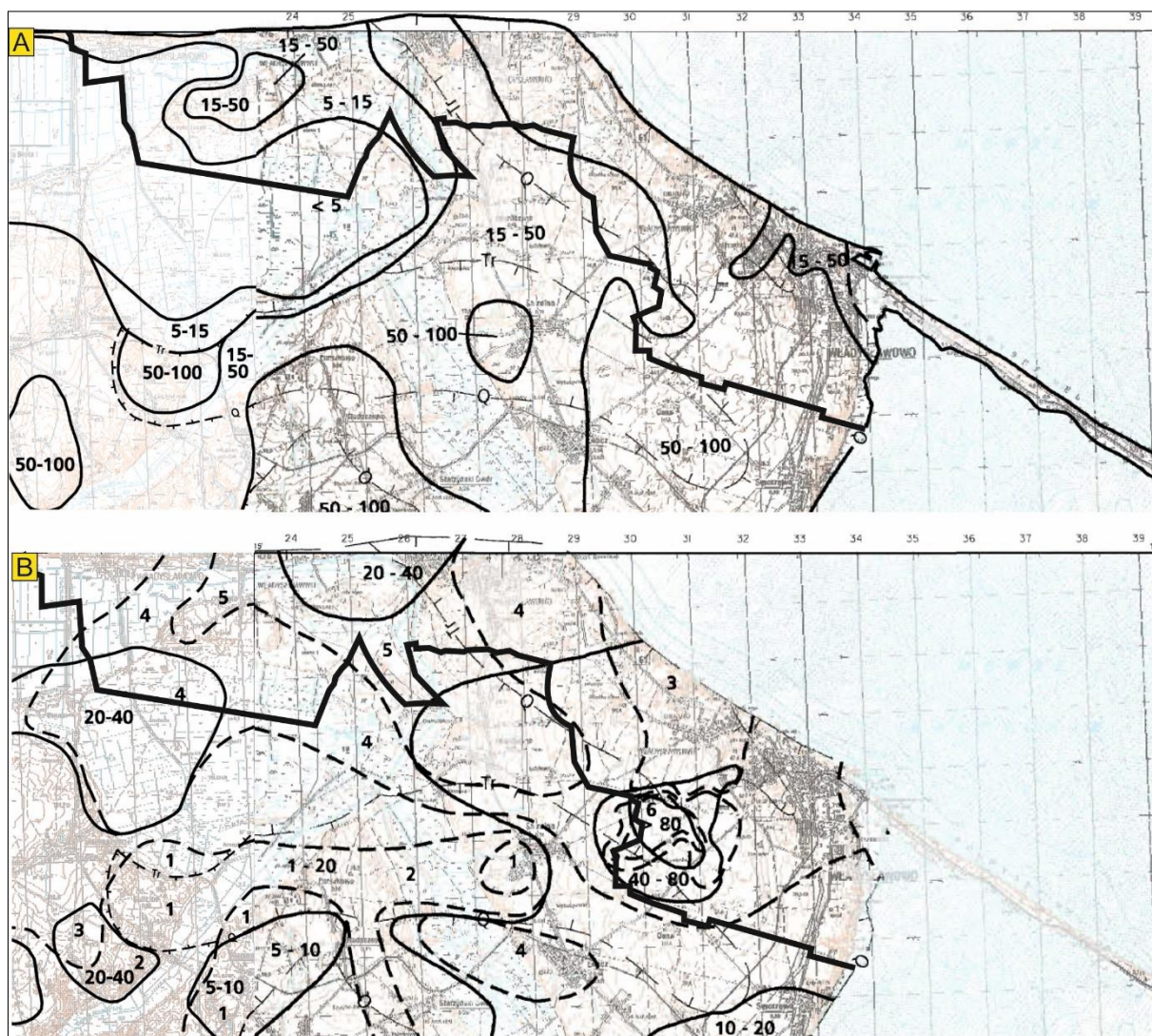
Rys. 3. A – mapa głębokości występowania głównego poziomu wodonośnego. B – mapa miąższości i przewodności głównego poziomu wodonośnego
